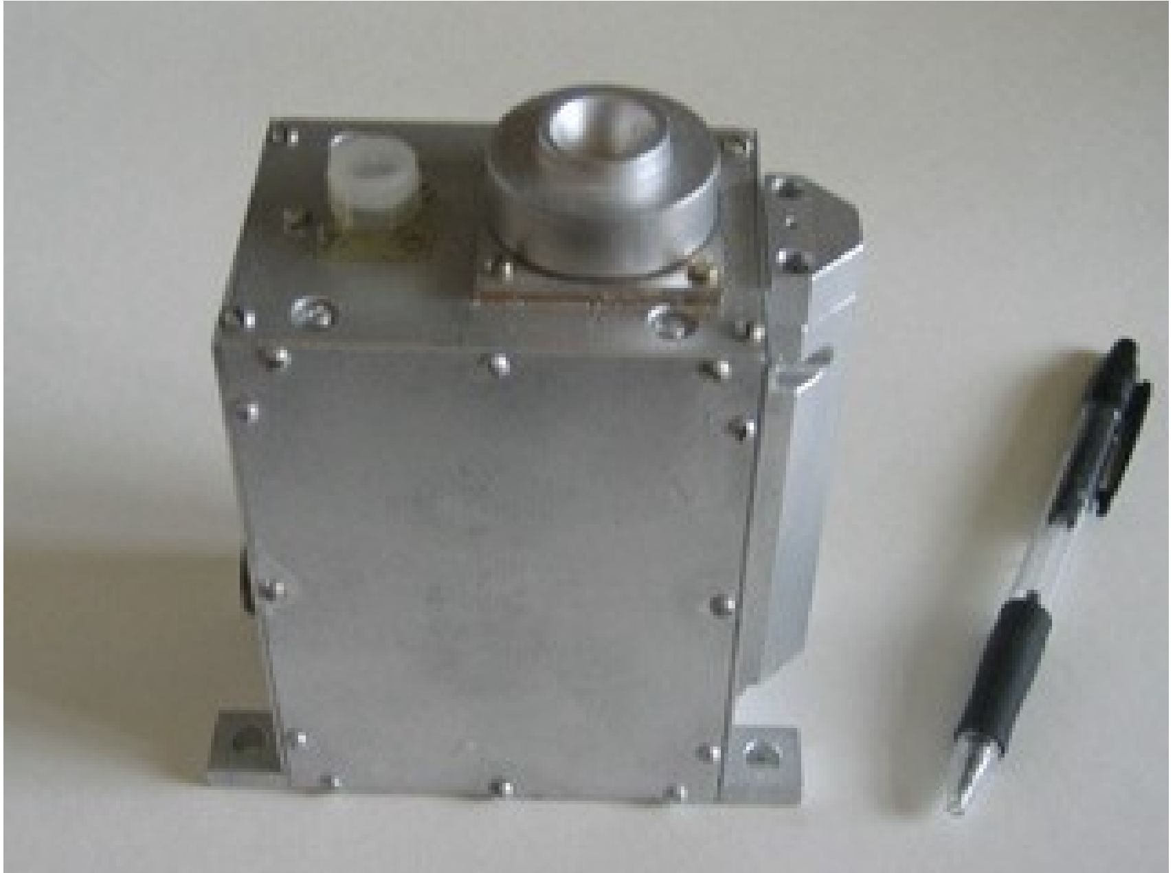
д) детектор радиации, предназначенный для измерений электронов и протонов радиационных поясов Земли и космических лучей
